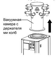
• Снимите вакуумную камеру с креплениями для колб с холодной ловушки. Если на стенке ловушки образовался лед, включите переключатель разморозки.
